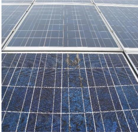
Abbildung 14-7 Glasbruch – vermutlich durch Überhitzung
