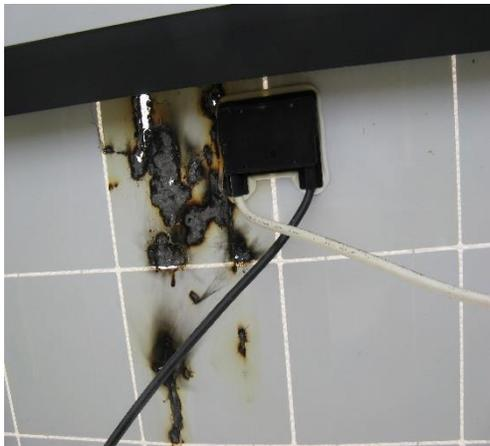
Abbildung 14-8 Überhitzte Zellen von unten
